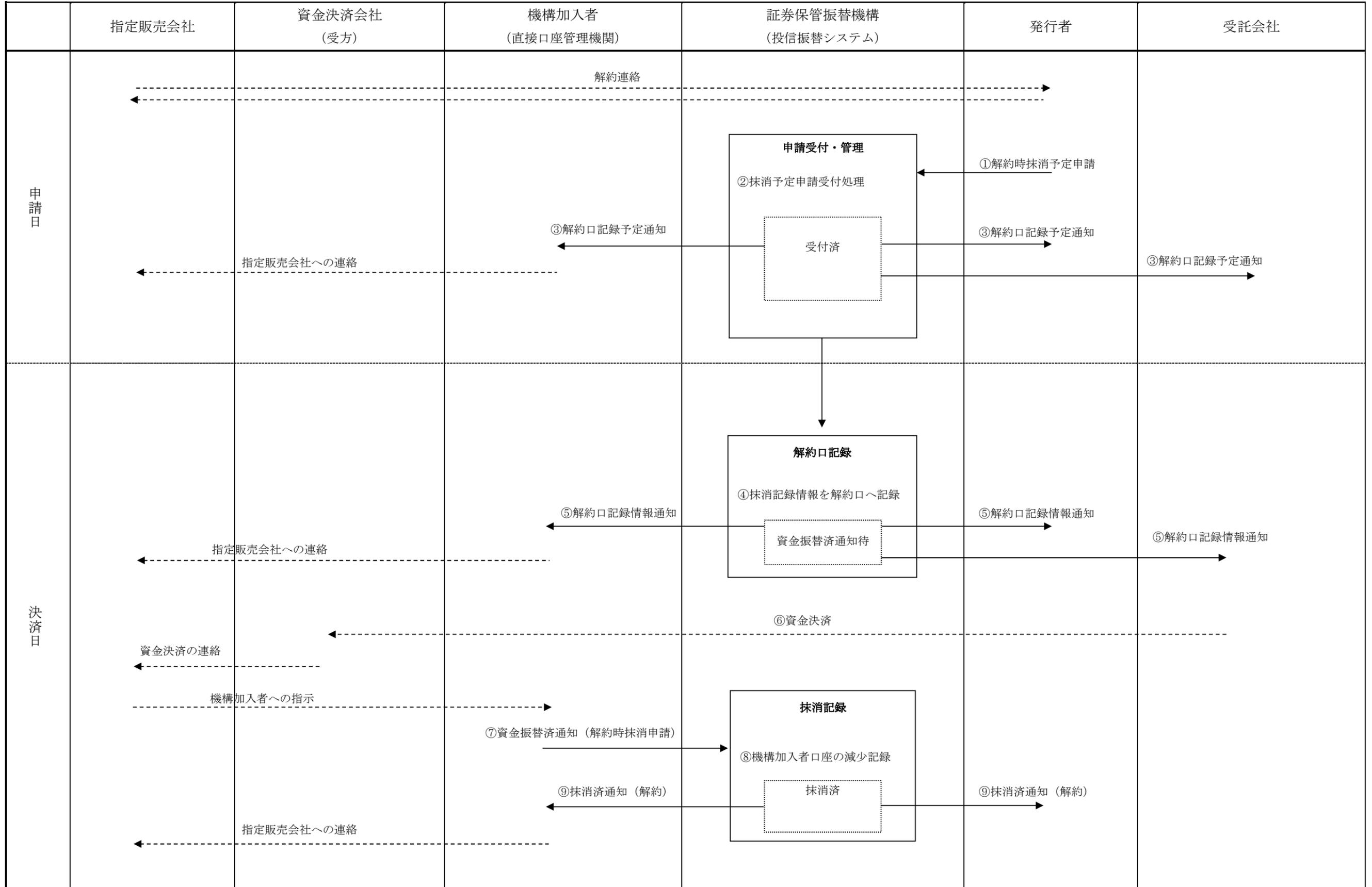
← (実線) 投信振替システムにおけるデータ   ←--- (破線) 投信振替システム外でのデータ   □ (実線枠) システム処理   ▭ (点線枠) 進捗ステータス
